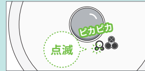
■LED非常用照明器具の モニターランプ例
