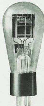
的のために、新しく製作された半波整流管である。其の規格は次の通りである。
