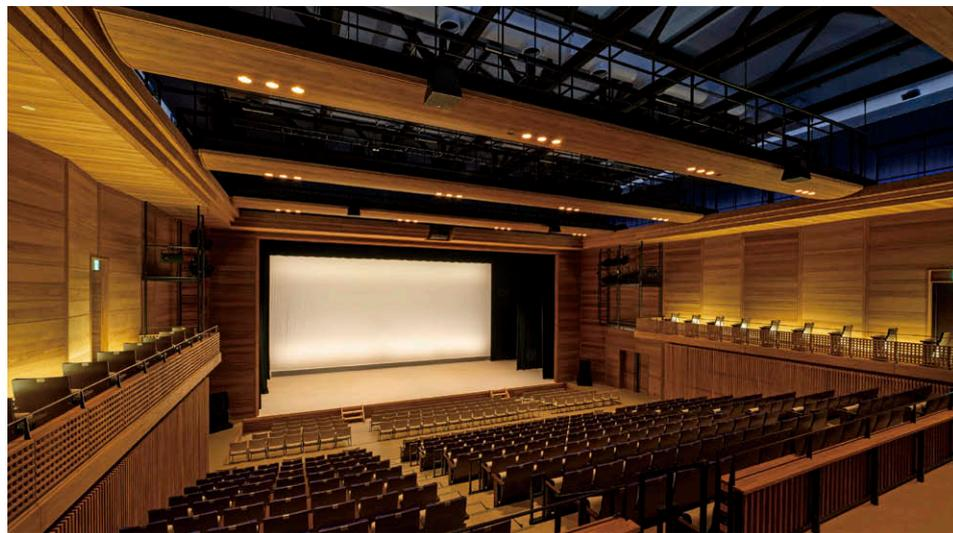
多目的ホール（水平使用時） キャットウォーク下面に、調光に連動して色温度が変化するLEDシアターシリーズダウンライト①②を配置し、特別な劇場空間を創出。
