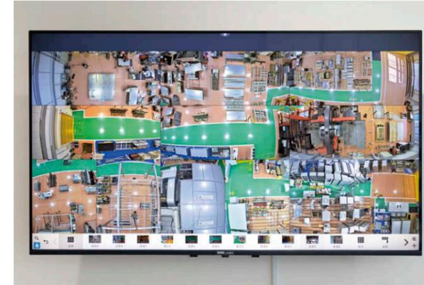
カメラ映像表示ディスプレイ エントランスに設置されたディスプレイにViewLED①の映像を表示。表示させる「Axis Camera Station」を別途契約することで1台から任意の複数台、さらには全カメラ一括表示まで自由に選択。左の掲載写真は12か所のカメラ映像表示。
