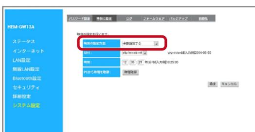
6. 『時刻の設定』画面が表示されたら、[時刻の設定方法] で『手動設定する』を選択します。
