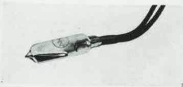
第1圖 B 水銀とタングステンの接觸水銀スイッチ(F型)
