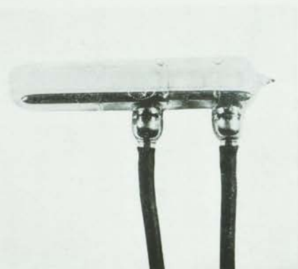
第2圖 標準B型水銀スイッチ、開閉の部分に入れてある硝子管は火花の害を防ぐ爲であります。
