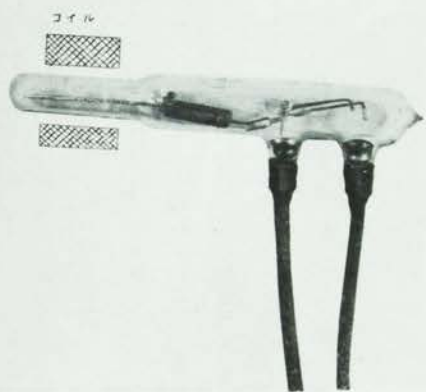
第9圖 コイルの作用により動作する水銀スイッチ
