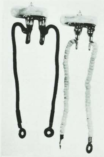
第1圖 A 水銀面接觸の水銀スイッチ B型 左側は綿絶縁線、右側は瀬戸絶縁線であります。
