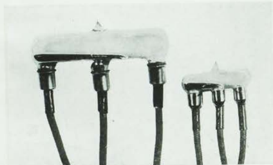
第4圖 C型水銀スイッチ、端子を同一平面上に三個有す。
