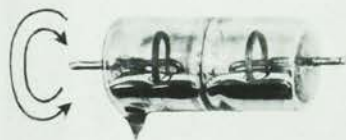
第10圖 回轉により開閉する水銀スイッチ
