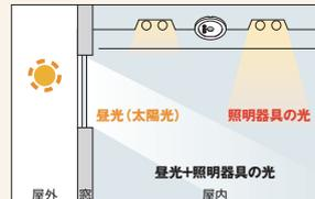
明るさセンサーが昼光による明るさアップ分を検知し照明を制御
