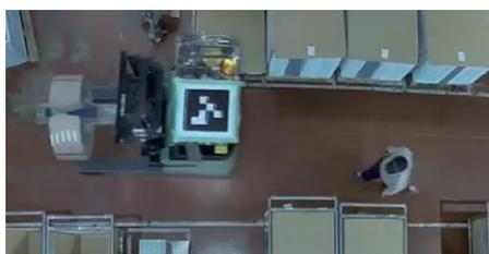
人とフォークリフトの近接を本人や運転者に通知するため、死角からの飛び出しや接触リスクの抑制が図れます。危険な接近をタイムバーとダイジェスト画像でスピーディに抽出できます。
