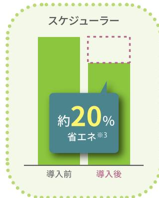
※3 計算条件: (一社) 日本照明工業会発行 照明器具リニューアルのすすめ (照明器具カエル BOOK2023) P.6より引用 8~9時、19~22時:50%点灯、12~13時:25%減光、9~12時、13~19時:100%点灯のスケジュール制御時の一例
