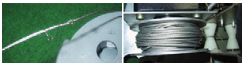
素線の切れた状態
