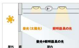
あかりセンサーが昼光による明るさアップ分を検知し照明を調光制御 あかりセンサーの調光制御
