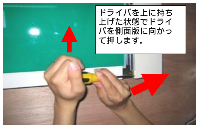
④ ドライバをてこの原理で持ち上げた状態で、側面板に向かって押します。
