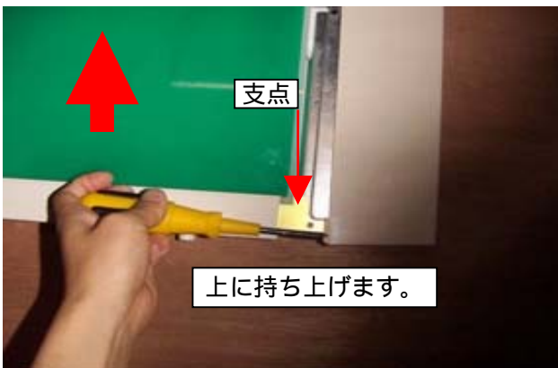
③ 差し込んだドライバを、本体下面板を支点に上に持ち上げます。 ※このとき、内部で勘合している爪の部分をドライバの先端が押し下げます。 ※外した側面板は使用しません。ドライバは強く押し上げてください。
