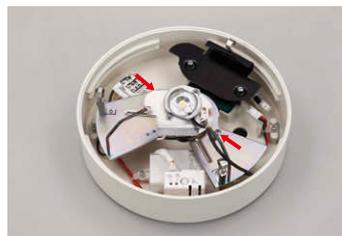
①ネジ(→)を緩めてランプソケット・非常用LEDモジュール(一体化)を外します。
