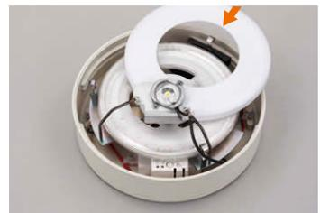
③ランプソケット・非常用LEDモジュールをネジ止めし、ランプを取り付け、ランプカバーを横からはめ込みます。
