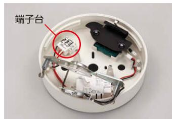
②Fケーブルを引き込み、天井(または壁)に本体を設置します。Fケーブルを器具端子台に差し込み、蓄電池のコネクタを接続します。
