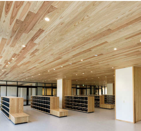
昇降口 府中市の姉妹都市である長野県佐久穂町産のカラマツの木を使用した広い空間にLEDダウンライト⑤を設置
