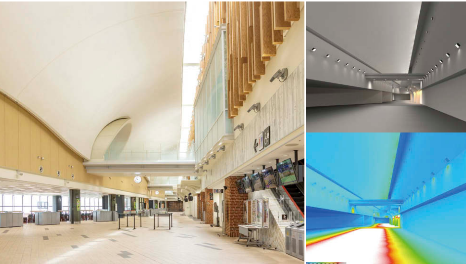
簡易CG(右)によるシミュレーション LED投光器①②③の配光イメージを簡易CGにより確認
