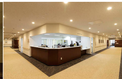
10階スタッフステーション付近の照明 入院病棟の廊下にも温かみのあるLEDダウンライト①を採用
