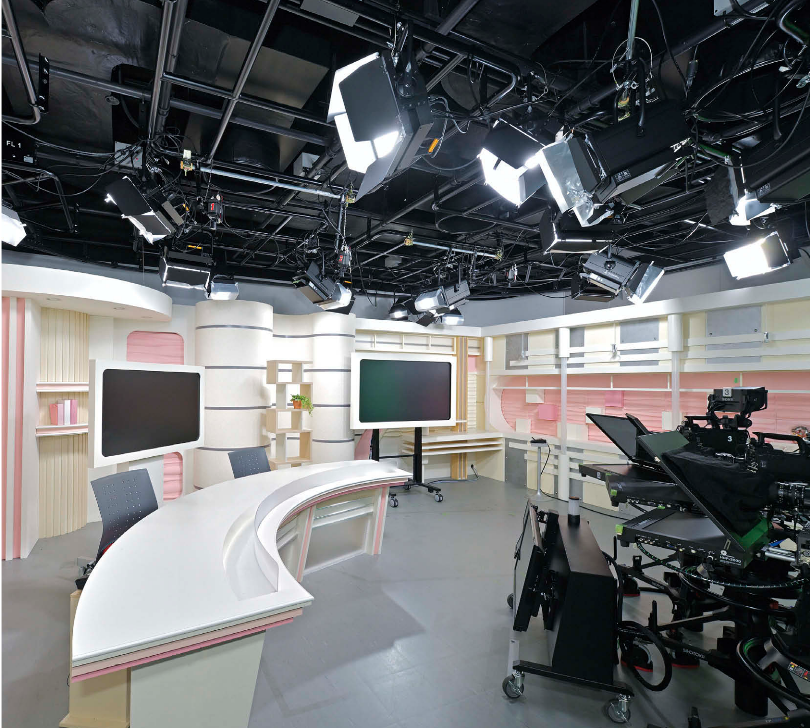
メインセット LEDフラッドライト①で空間に光を満たし、LEDスポットライト②で人物を照射
